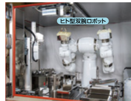
全自動の抗がん薬調製支援装置。ヒト型双腕ロボットがきめ細かな動きで抗がん薬を調製する。 提供:九州大学病院薬剤部
