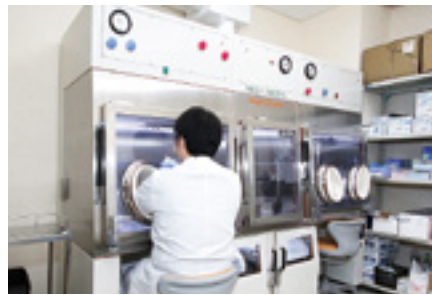
外来化学療法室に隣接して設けた調製室にはアイソレーターを導入し、調製時の抗がん薬曝露を極力抑えるよう配慮している。
